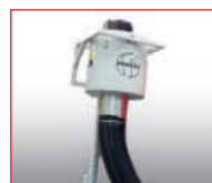
Absaugung des Ölnebels und der Kühlflüssigkeit
