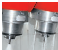
Kühlschmierung mit innerer und äußerer Zuführung
