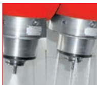
Kühlschmierung mit innerer und äußerer Zuführung
