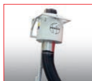
Absaugung des Ölnebels und der Kühlflüssigkeit
